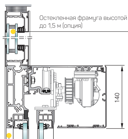
SL 35-S Несущий профиль 140 мм с самонесущим профилем и боковыми экранами
